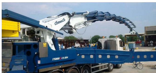
Кран — мировой рекордсмен, с грузоподъемностью 80 тонн
